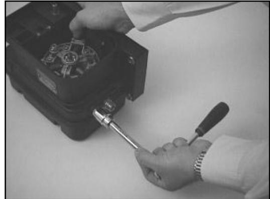
2. Kontrollieren Sie die Adapter und deren O-Ringe auf Beschädigungen und wechseln Sie sie erforderlichenfalls aus.
