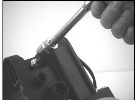
4. Entfernen Sie das Füllfilter mit einem 19-mm-Imbusschlüssel.
