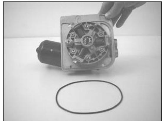
14. Montieren Sie die Pumpenbaugruppe wieder in das Pumpengehäuse (4 Imbusschrauben).
