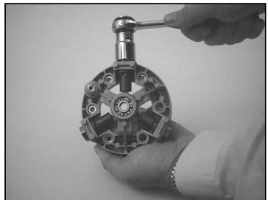
16. Entfernen Sie das Überlaufventil (achten Sie auf den Kupferring!).
