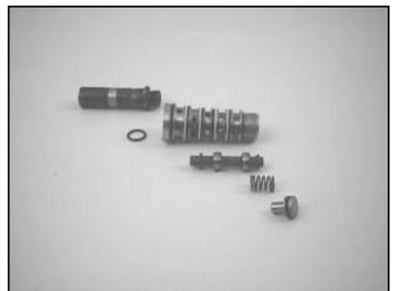
11. Montieren Sie die Spule, den O-Ring und die federnde Klemme.
