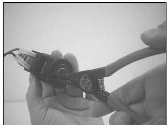
9. Kontrollieren Sie den O-Ring (1) auf Beschädigungen. Wechseln Sie ihn erforderlichenfalls aus.
