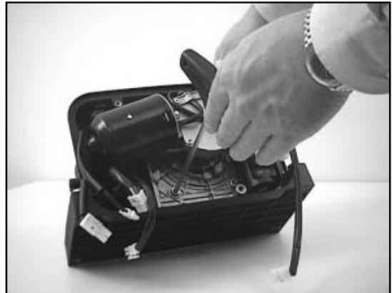
5. Kontrollieren Sie die Dichtung (1) zwischen der Pumpenbaugruppe und dem Pumpengehäuse.
