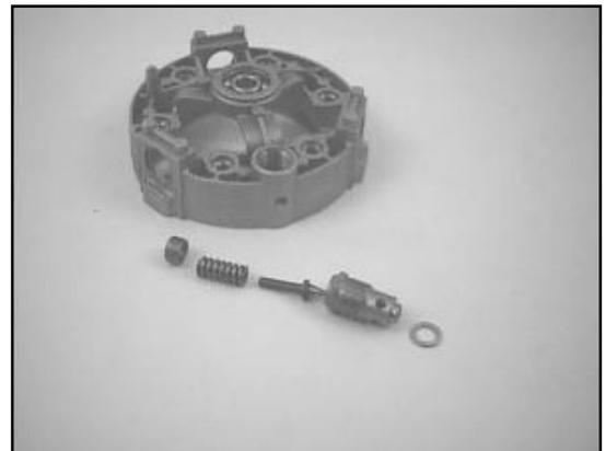
18. Montieren Sie das Überlaufventil (achten Sie auf den Kupferring).
