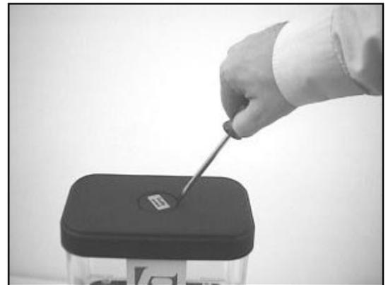
2. Lockern Sie die Schraube des Führungstifts und nehmen Sie den Deckel ab.
