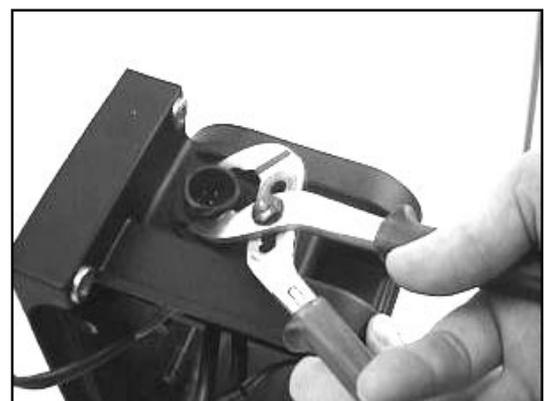
6. Kontrollieren Sie die Dichtung (1) des Steckers und wechseln Sie sie gegebenenfalls aus.
